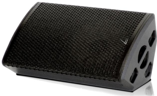
Le retour de scène M15 est une enceinte 2 voies, commutable actif/passif, équipée d'un haut parleur en Kevlar de 15" (38cm) à aimant néodyme pour le medium/grave et d'un moteur à compression 1,5" à aimant néodyme pour l'aigu, chargé par un pavillon de type « guide d'onde de Geddes » avec une directivité conique de 50°.
