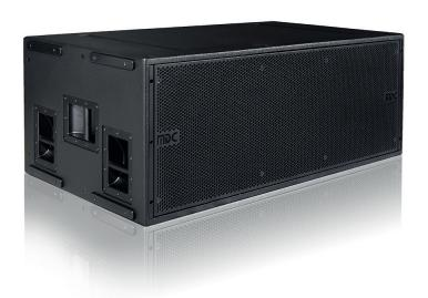
Complément des enceintes Sector Renfort de grave (preset 80-100Hz) Voie infra grave (preset 60Hz) Preset cardioid disponible Accrochage en array SUB - GRAVE forte puissance - 2 x 18" Principe acoustique bass-reflex évent à profil haute vitesse 2 x 18" Neodyme 3600W-AES/7200W-PGM 4 Ω Système d'accroche
